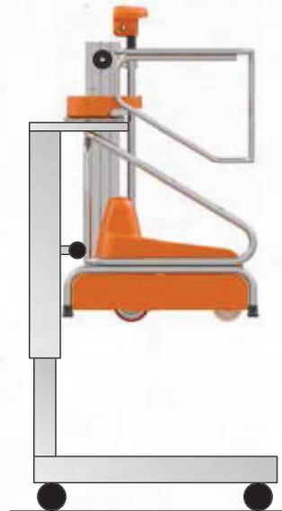
le montant du chariot est télescopique pour pouvoir être réglé en hauteur, en fonction du plan sur lequel la machine doit être chargée.
